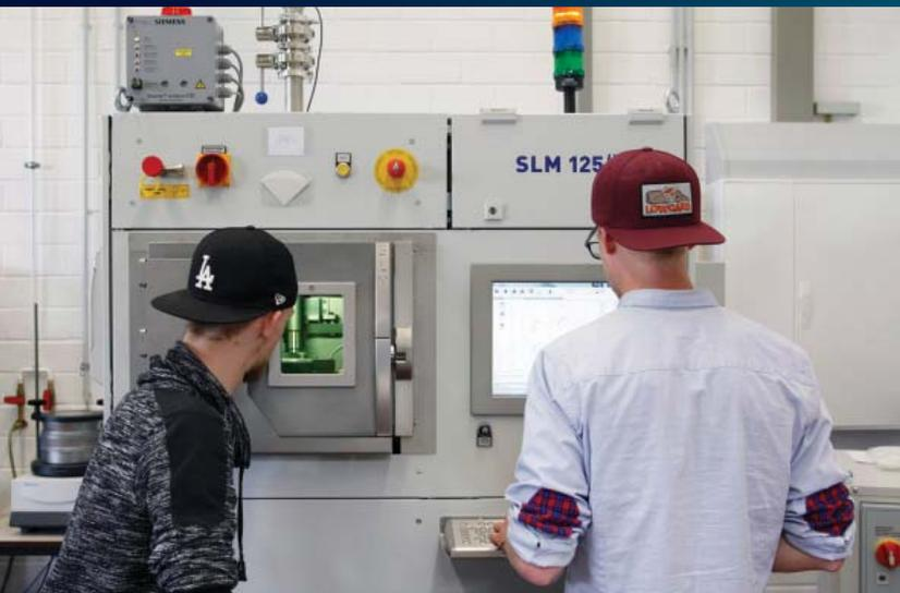
Studierende an der Hochschule Bochum produzieren die Objekte, die sie mit NX konstruieren und in Teamcenter verwalten, mittels additiver Fertigung im selektiven Laserschmelzverfahren.
